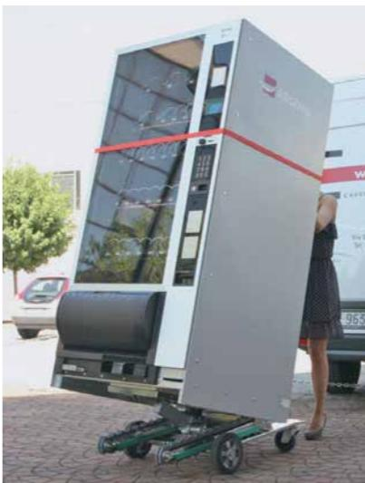
soporta pesos de hasta 400 kilos, las carretillas permiten mover la máquina con el mínimo esfuerzo, subir unas escaleras o reubicarla en un espacio de difícil acceso.
