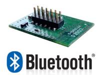
Un pequeño módulo Bluetooth opcional puede integrarse en la tarjeta de sistema para transferir rápidamente los datos contables desde el monedero de cambio a un ordenador palmar Bluetooth compatible, sin tener que quitar el sistema de la máquina y sin necesidad de conexiones cableadas.
